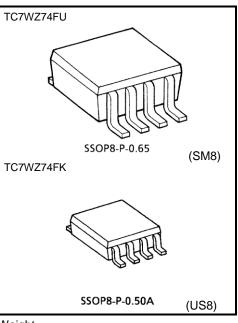
Weight SSOP8-P-0.65 : 0.02 g (typ.) SSOP8-P-0.50A : 0.01 g (typ.)
