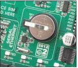
Figure 10-1: RTC module
