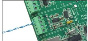
Figure 7-1: ADC module
