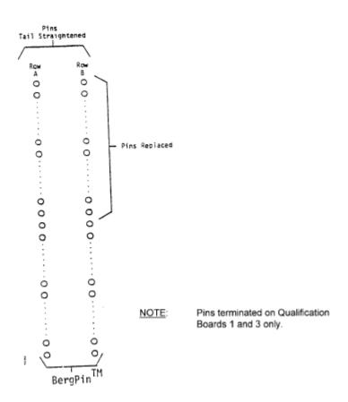
FIGURE 5 – TEST SAMPLE CONFIGURATION
