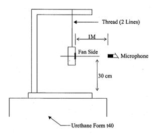
1 METER FROM MICROPHONE TO FAN INTAKE
