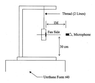
1 METER FROM MICROPHONE TO FAN INTAKE
