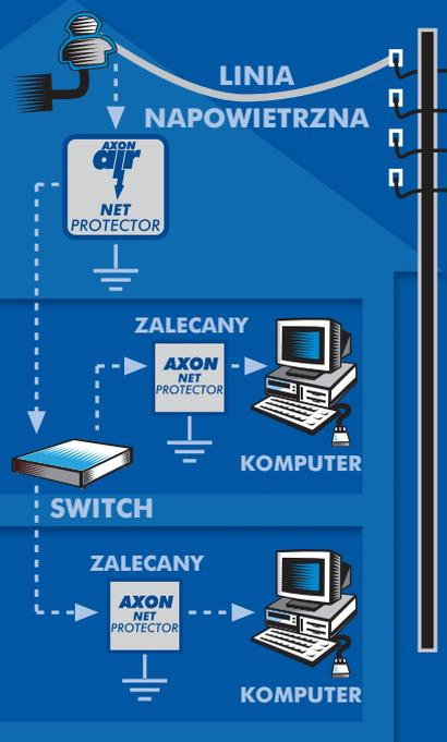
**AXON Net Protector** przeznaczony jest do ochrony przeciwprzepięciowej urządzeń dotychczas do sieci Ethernet 10/100/1000 Mb/s. Zastosowane elementy zabezpieczają wszystkie 4 pary przewodów w skłętce. W obrębie każdej pary zapewniona jest eliminacja przepięć pomiędzy liniami, a pojawiający się ładunek odprowadzany jest do ziemi poprzez przewód ochronny PE. Takie rozwiązanie gwarantuje skuteczną ochronę przeciwprzepięciową.
