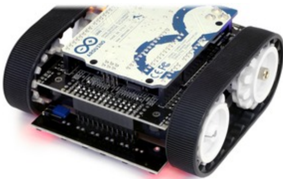
Zumo reflectance sensor array on a Zumo robot.
