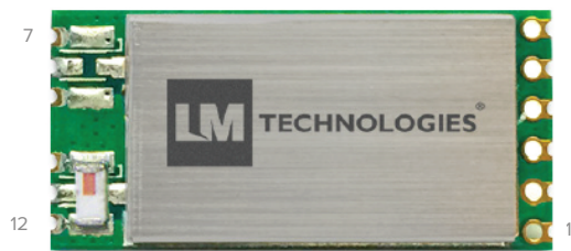
RF Type 2: IC Antenna Module
