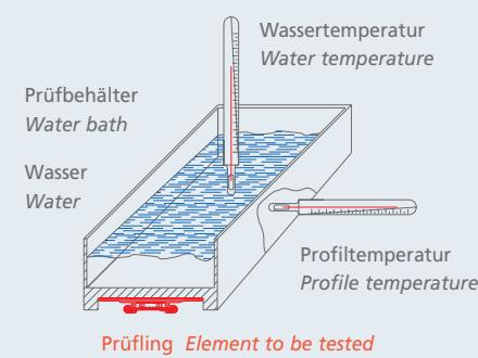
\* Leistung in einer wassergefüllten Aluminium-Referenzprüfwanne mit guter Wärmeableitung: Ausgangs- und Umgebungstemperatur 20°C
