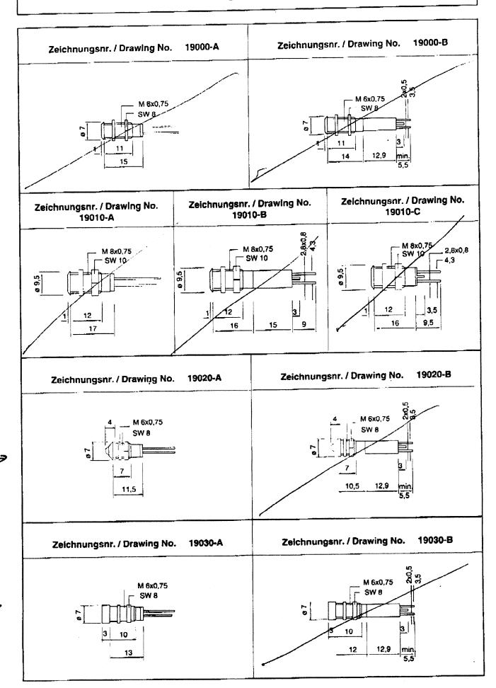
Led Signalleuchten Einbaudurchmesser 8 mm Led Indicators Body diameter 8 mm
