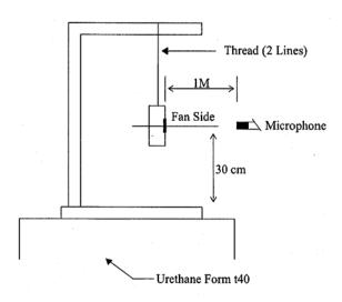
1 METER FROM MICROPHONE TO FAN INTAKE
