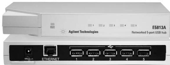
Utilice la red local para acceder a distancia a dispositivos o instrumentos USB, GPIB o RS-232
