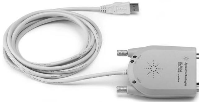
Se conecta rápidamente a una interfaz GPIB a través del puerto USB del PC
