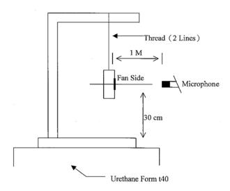
1 METER FROM MICROPHONE TO FAN INTAKE
