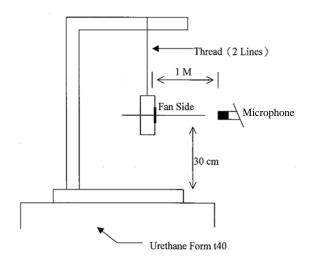
1 METER FROM MICROPHONE TO FAN INTAKE
