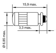
Lampensockel nach DIN EN 60061-1: S5,7s / Lamp base in accordance to DIN EN 60061-1: S5,7s
