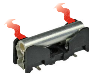
Abbildung 5: UL/CSA-Test mit Silberrohr
