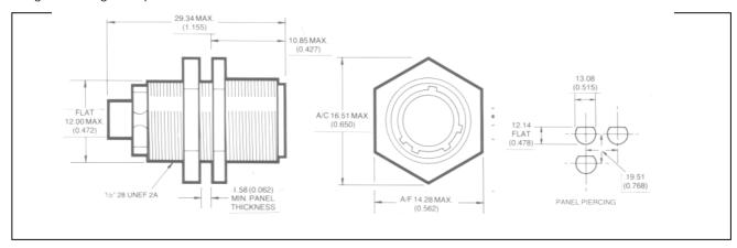
Sq. Flange Mtg. Receptacle - 711-5002/C2835-/PAN 6484 B
