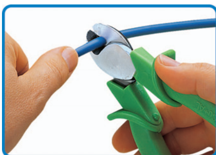
Cutting og cable
