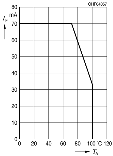
Max. Permissible Forward Current Max. zulässiger Durchlassstrom I_{F,max} = f(T_A), R_{thJA} = 380 \text{ K/W}
