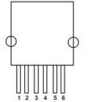
PIN 1) TEMPERATURE OUTPUT (+) PIN 2) Vs PIN 3) + OUTPUT PIN 4) GROUND PIN 5) - OUTPUT PIN 6) TEMPERATURE OUTPUT (-)
