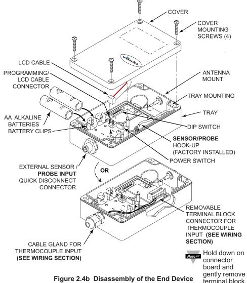
Figure 2.4b Disassembly of the End Device (zED-x-LCD-AA or zED-TC-LCD-AA)
