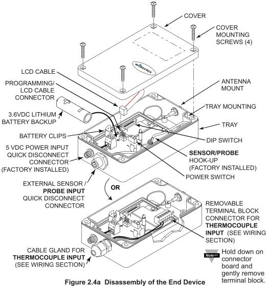
Figure 2.4a Disassembly of the End Device (zED-x-P/zED-x-LCD or zED-TC-P/zED-TC-LCD)
