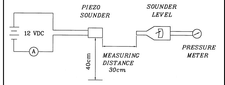
Mic: RION S.P.L meter UC30 or equivalent Mic: RION 噪音計 UC30 或同等品
