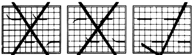
Réglez le condensateur ajustable dans le connecteur BNC avec un tournevis en plastic jusqu'à l'obtention d'un sommet le plus plat possible de la tension.
