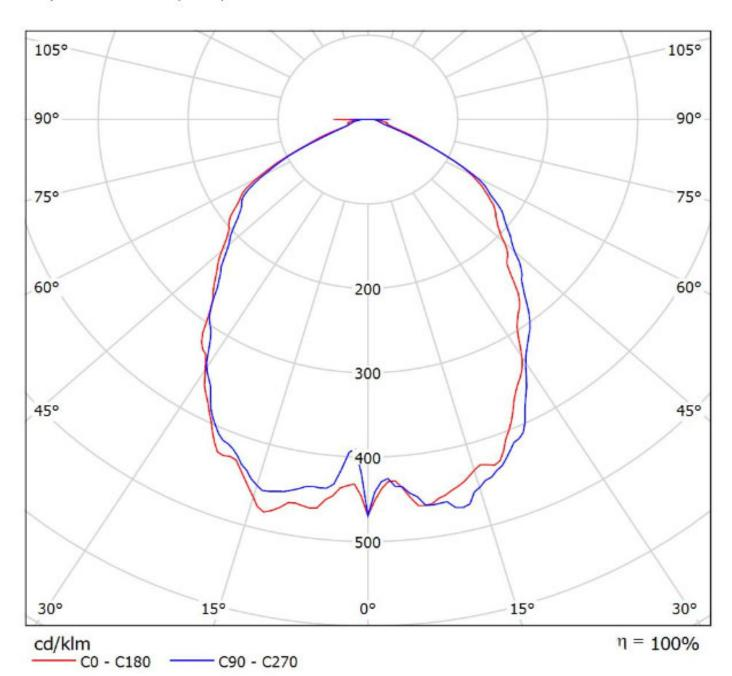
Luminaire: Ledil Oy CS16324\_STRADELLA-IP-28-HB-W\_(XP-G3)\_SIMULATED Lamps: 1 x Cree XP-G3
