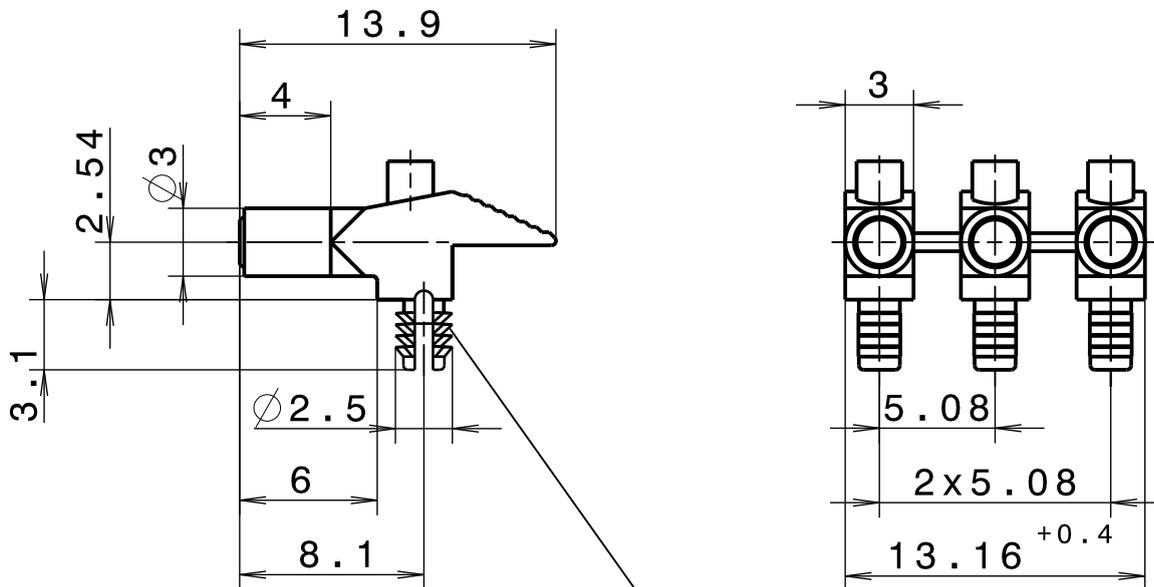
Montagebohrung PCB  $\varnothing 2,3 \pm 0.02$
