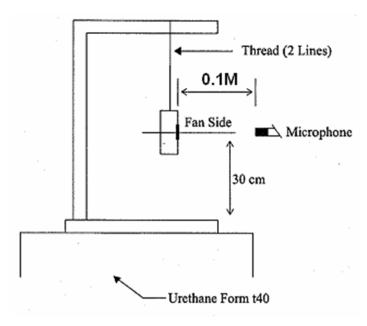
0.1 METER FROM MICROPHONE TO FAN INTAKE
