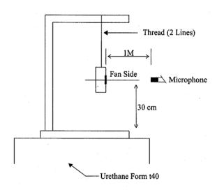
1 METER FROM MICROPHONE TO FAN INTAKE
