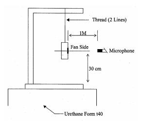
1 METER FROM MICROPHONE TO FAN INTAKE
