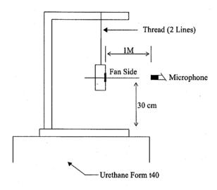
1 METER FROM MICROPHONE TO FAN INTAKE
