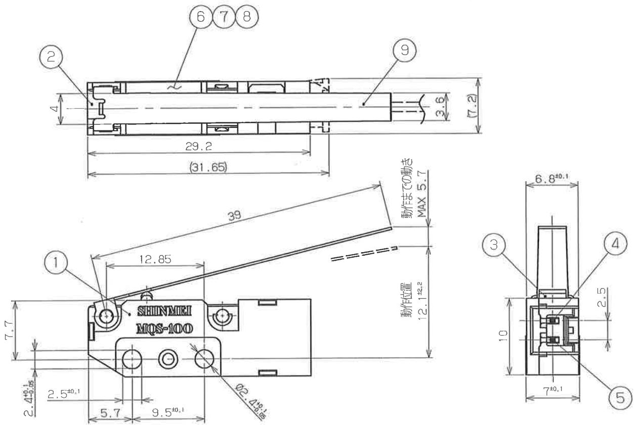
回路構成： 1回路 1接点 (COM-NO)
