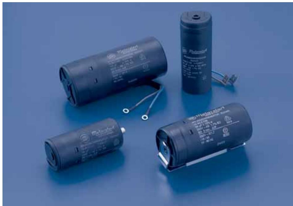
I condensatori elettrolitici vengono normalmente impiegati nei motori monofase ad induzione per aumentare il valore della coppia d'avviamento. Si richiede che tale avviamento avvenga in una frazione di secondo o al massimo di qualche secondo e con l'apporto di una elevata potenza reattiva.
