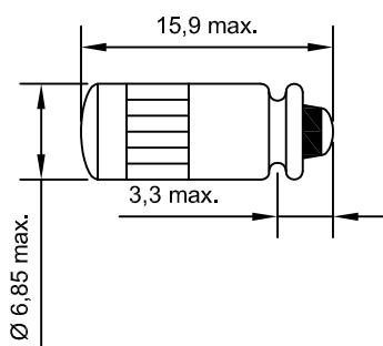
Lampensockel nach DIN EN 60061-1: S5,7s / Lamp base in accordance to DIN EN 60061-1: S5,7s
