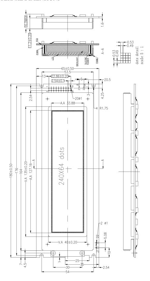
REMARKS: 1,UNMARKED TOLERANCE IS ±0.20 2,MATERIAL COMPLY WITH THE ROHS.
