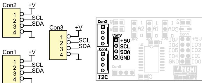
Linie GPIO ekspandera wyprowadzono na 10-stykowe złącze IDC Con4 w sposób pokazany na rysunku poniżej.
