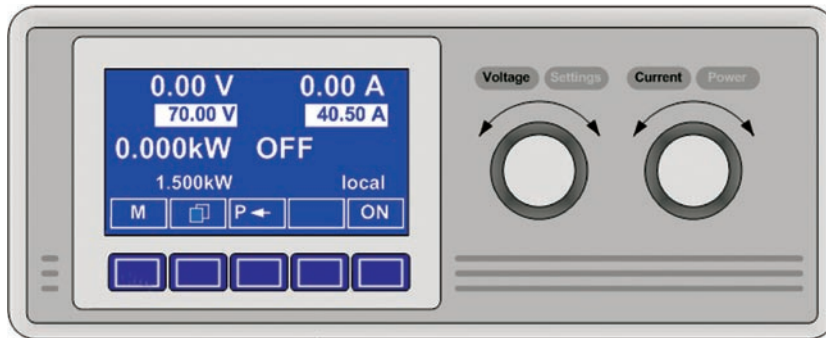
Drehgeber für Einstellungen Rotary encoder for settings
