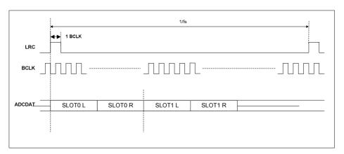
Figure 77 TDM in DSP Mode B
