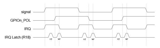
Figure 49 GPIO Edge Detect
