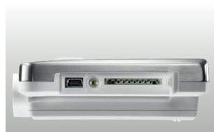
Connecteur latéral pour câble Mini-USB et carte SD
