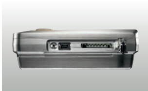
Puerto mini USB y ranura para tarjeta SD en el lateral
