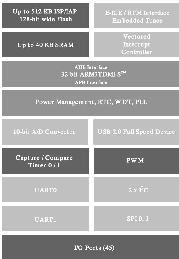
Rys. 2. Schemat blokowy mikrokontrolerów z rodziny LPC214x
