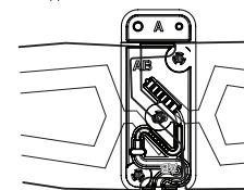
5. Coloque los orificios de la segunda aleta sobre la parte superior de los tornillos izquierdo y central. Las aletas se sobrepondrán levemente. Las letras AB impresas en la aleta deberán aparecer en la parte inferior derecha (boca abajo).
