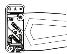
4. Coloque los orificios de una de las secciones de la aleta sobre la parte superior de los tornillos derecho y central. Las letras AB impresas en la aleta deben poder verse desde la esquina superior izquierda de la aleta.
