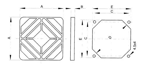
EMV-Schutzgitter für Lüftergrößen 80x80 bis 119x119mm. Diese Schutzgitter bestehen aus 3 Teilen: Der äußere Rahmen, die Staubfiltermatte und das EMV-Gitter aus metallisiertem Kunststoff, silberfarben, und einem Metallnetz. Damit wird eine hohe EMV-Filterwirkung bei Frequenzen zwischen 1MHz und 1GHz bei niedrigen Kosten erreicht. Das Metallnetz muß einen direkten elektrischen Kontakt zur metallischen Oberfläche des Gerätegehäuses haben.
