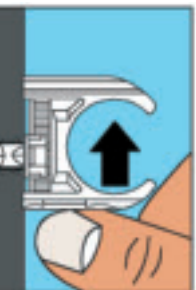
Ausrichten Euro-Clip kann durch ein Loch über die gesamte Breite ausgerichtet werden.
