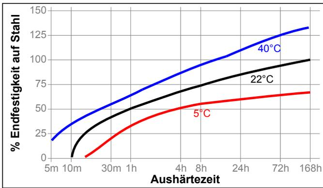
**Aushärtegeschwindigkeit in Abhängigkeit vom Aktivator**
