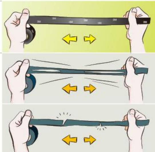
劣质胶带带基品质脆弱，两手拉伸带基表面出现断痕或裂纹，很容易断裂。
