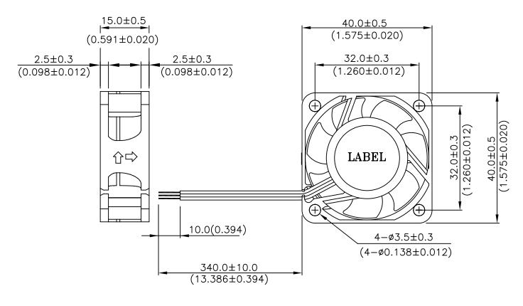
UL 1007 -F- AWG #24 BLACK WIRE NEGATIVE(-) RED WIRE POSITIVE(+) BLUE WIRE LOCK SIGNAL(-R00)
