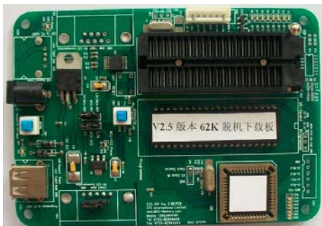
固件版本号为V2.5的脱机下载板
