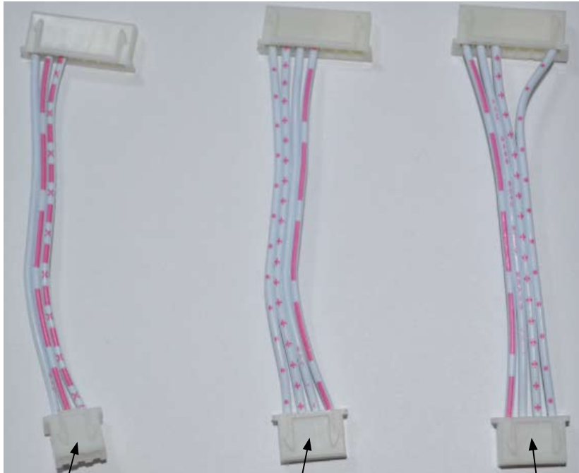
U7-S1与用户系统各自独立供电的连接线
