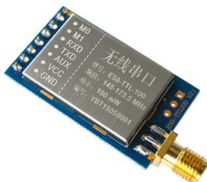
E50-TTL-100 是一款 170M 直插型无线串口模块 (UART)，半双工，收发一体，透明传输方式，发射功率 100mW，工作在 148~173.5MHz 频段 (默认 170MHz)，TTL 电平输出，兼容 3.3V 与 5V 的 IO 口电压，具有空中唤醒功能 (超低功耗)。
