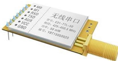
E31-TTL-50 是一款基于瑞士 AXSEM 原装进口 AX5043 射频芯片的 433M 直插型无线串口模块 (UART)，半双工，收发一体，透明传输方式，发射功率 50mW，工作在 425~450.5MHz 免费频段（默认 433MHz），TTL 电平输出，兼容 3.3V 与 5V 的 IO 口电压，具有空中唤醒功能（超低功耗）。
