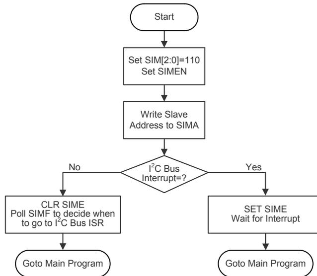
I<sup>2</sup>C 总线初始化流程图
