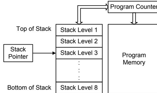
如果堆栈已满，且有非屏蔽的中断发生，中断请求标志会被置位，但中断响应将被禁止。当堆栈指针减少 (执行 RET 或 RETI)，中断将被响应。这个特性提供程序设计者简单的方法来预防堆栈溢出。然而即使堆栈已满，CALL 指令仍然可以被执行，而造成堆栈溢出。使用时应避免堆栈溢出的情况发生，因为这可能导致不可预期的程序分支指令执行错误。若堆栈溢出，则首个存入堆栈的程序计数器数据将会丢失。
