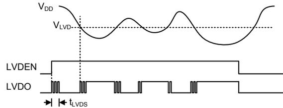
LVD 操作低电压检测器也有自己的中断功能，也是属于多功能中断的一种，它是除了轮询 LVDO 位之外的另一种检测低电压的方法。中断条件产生置位 LVDO 并延时  $t_{LVD}$  后，中断产生。此种情况下，若  $V_{DD}$  降至小于 LVD 预置电压值时，中断请求标志位 LVF 将被置位，中断产生，单片机将从休眠或空闲模式中被唤醒。若不要求低电压检测的唤醒功能使能，在单片机进入休眠或空闲模式前应将 LVF 标志置为高。当 LVD 功能使能后，建议在使能相关中断前先将 LVD 中断标志位清零以避免错误操作。
