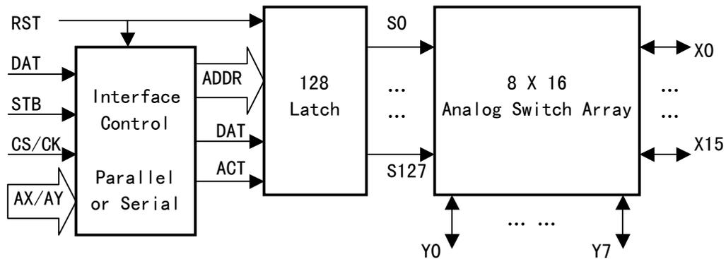
CH446X 是 5x24 矩阵模拟开关芯片。CH446X 包含 120 只模拟开关，分布于 5x24 信号通道矩阵的各个交叉点，每只模拟开关都可以独立的开启或者关闭，从而实现 5x24 信号通道的任意路由。
